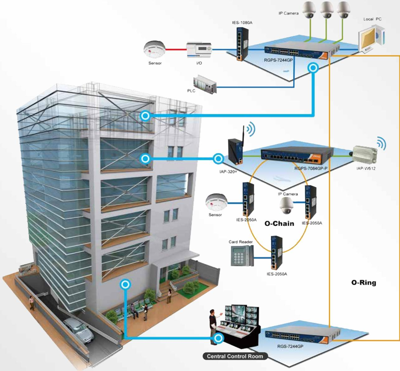
نظام إدارة المباني هو نظام للتحكم والتشغيل وإدارة كافة عمليات المبنى (أو المنشأة) بشكل مركزي كما يشمل التحكم بمراد المبنى ( كالتدفئة، الإنارة، المصاعد) والربط مع أنظمة التيار الضعيف مثل كاميرات المراقبة والصوتيات ونظام إنذار السرقة ونظام التحكم بالدخول والخروج ونظام إنذار الحريق وإدارتها عن طريق نظام واحد متكامل
